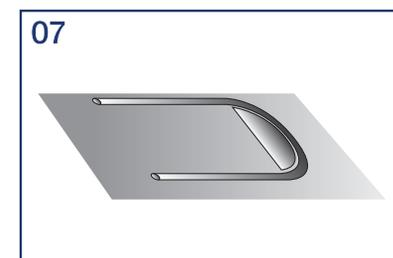
07 Una vez rolado el perfil o tubo verificar el radio ya sea con la plantilla o con el trazo en el piso bajándolo de la maquina las veces que sea necesario.
