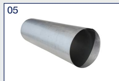
05 Una vez rolado el cilindro puntearlo antes de bajarlo de la maquina para darle una última pasada al rolado, verificándolo las veces que sea necesario el radio, ya sea con plantillas o con el trazo en el piso.
